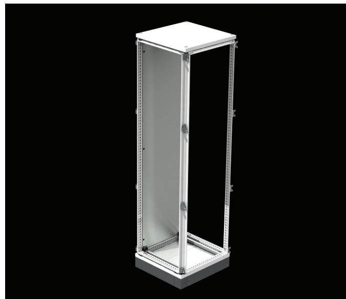
3,00mm galvaniz sacdan üretilen TEOS montaj plakaları kıraklı ve kolay takma şekli kullanıcıya rahatlık sunar. Kalın sac yapısı ile ağır ekipmanların montajında esneme yapmaz ve ilave yan desteklere ihtiyaç duymaz. Böylece birleşen panolarda panolar arası kullanım alanı genişler. Montaj plakası ilave parça gereği olmaksızın ileri-geri pozisyon değiştirilebilir.
