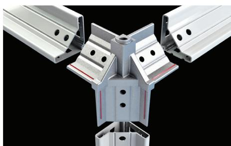
Alüminyum köşe birleştirici üzerinde bulunan topraklama tırnakları profillerin boyasız olan iç yüzeyine sıkıca ve aşındırarak montajlanır. Böylece tüm profillerde ve onlara takılacak parçalarda topraklama sürekliliği sağlanmış olur.
