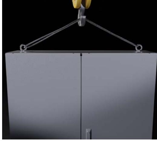
Açılılarda taşıma kapasitesi Her bir eyebolt için; 45 Derece F = 2400 \text{ N} 60 Derece F = 3200 \text{ N}
