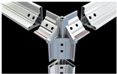
Расположенные на угловых элементах, заземляющие скобы плотно прилегают к непокрытой внутренней поверхности профиля рамы посредством эрозии. Таким образом, обеспечивается непрерывность заземления для всей конструкции рамы.
