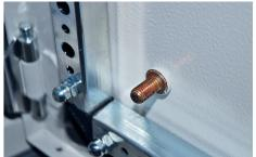
Расположенная на внутренних частях передней двери в нижней и верхней части, шпилька заземления увеличивает проводящую поверхность. Таким образом, обеспечивается более эффективное заземление передней двери как наиболее важной части, подлежащей заземлению.
