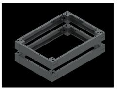
Цоколь имеет два исполнения высотой 100 и 200 мм. Передние части угловых элементов открыты. Это позволяет не только легко монтировать шкаф, но и легко крепить его к полу. По завершении монтажа, открытая часть цоколя закрывается пластиковой заглушкой.
